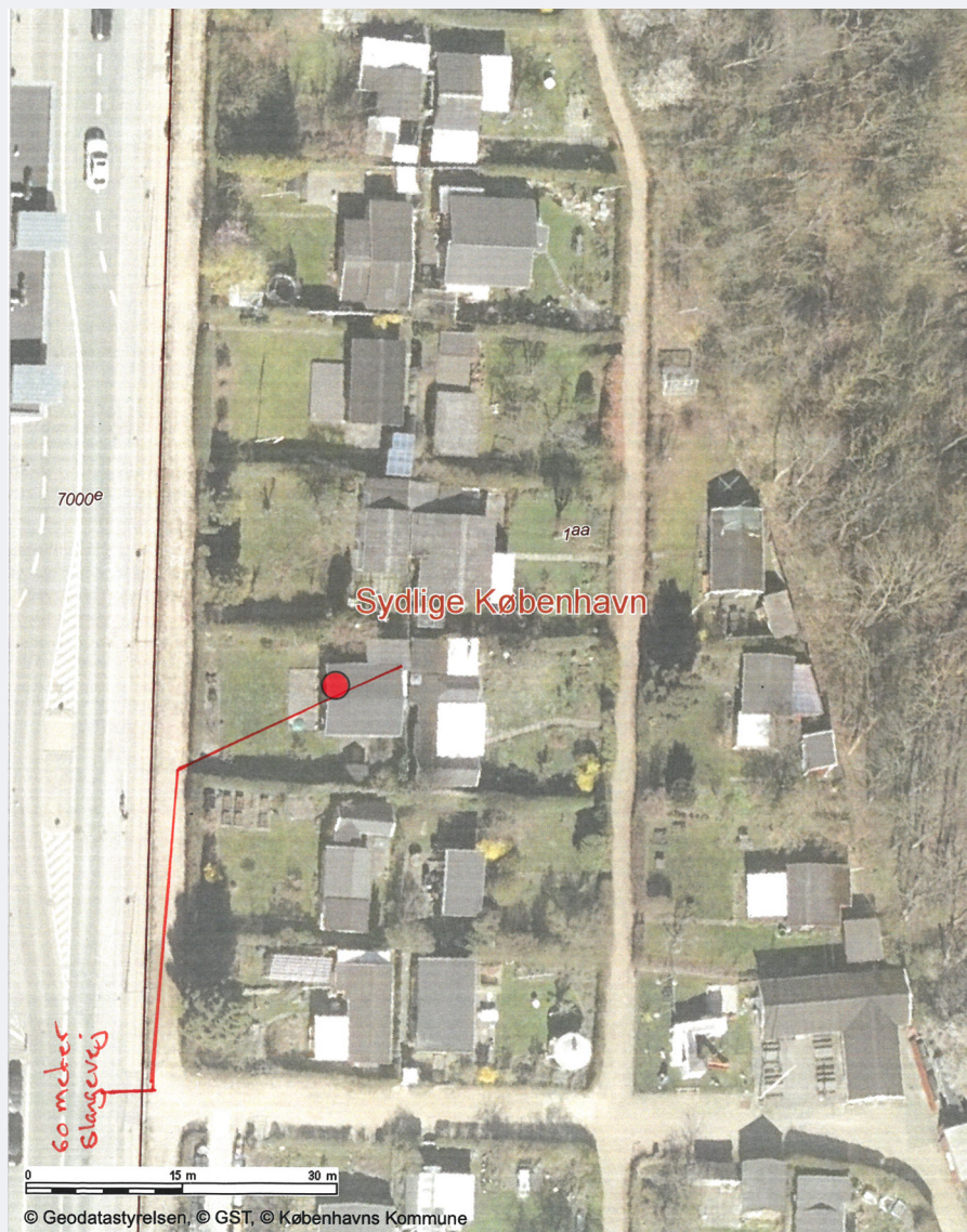
Figur 3. Situationsplan med angivelse af, at brandbil kan holde på gade eller godkendt brandvej max. 80 m fra dit hus "slangevej".
